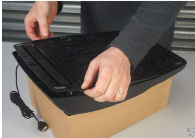
Nota come è disposto e fissato il cablaggio alla modanatura in plastica. In seguito dovrai rimettere i cavi nei posti corretti.
