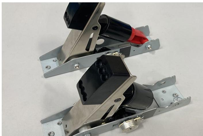
Réinstallez l'embrayage dans le boîtier de la pédale et connectez les fils rouges, verts et noirs.
