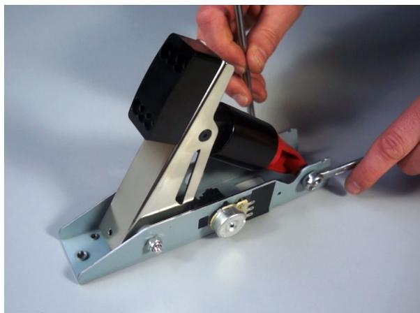
Retirez le boîtier du ressort inférieur de la pédale de frein, le ressort et le bloc de caoutchouc (le cas échéant).
