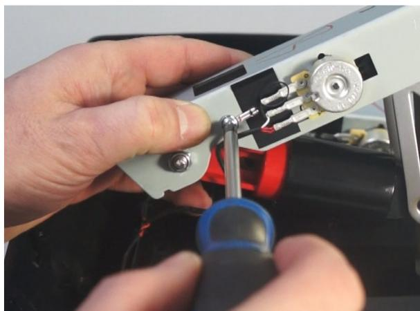
**ATTENTION:** Les fils sont très fins et facilement endommagés. Ne déconnectez pas les connecteurs en tirant sur les fils.
