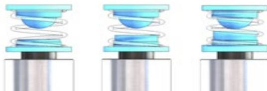
Insérez le dôme dans le boîtier supérieur du ressort. La découpe en forme de « Y » doit s'aligner avec les ailettes en forme de « Y » à l'intérieur du boîtier.
